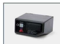
P111274 - RME Détecteur de masses métalliques monocanal avec socle d'installation. Alimentation 24 Vca. Led d'alimentation. Led canal. Configuration : impulsion au relâchement. Relais de présence avec fonctionnement par impulsion ou continu. Relais à impulsion avec possibilité de désactivation.
