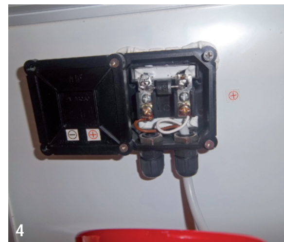
4 Collegare lo spinotto dal retro del pannello solare con Ecosol Box, utilizzando il connettore posizionato sulla sinistra di quest'ultimo. Applicando un cavo 2 x 0,75 mm si arriva a una distanza massima consigliata di 3 m tra Panel e Box
