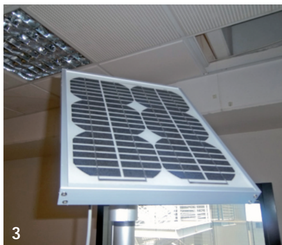
3 La prima operazione è cablare il pannello solare, inclinandolo in maniera che sia perpendicolare rispetto ai raggi solari
