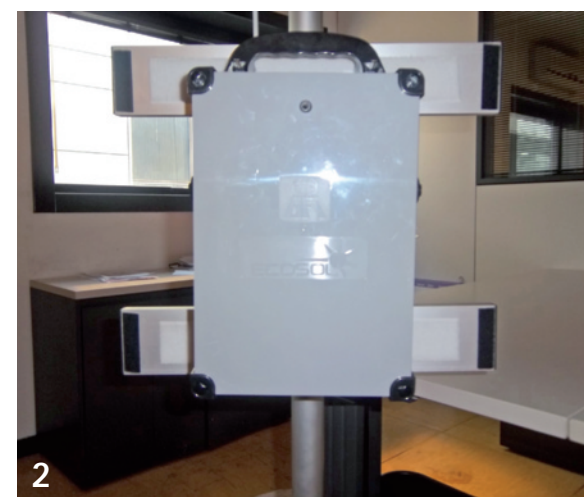
2 Ecosol Box: un'interfaccia per centrali di comando a 24V composta da 2 batterie da 7,2Ah e di una ricevente Clonix incorporata. È dotata di maniglia da asporto per poter essere facilmente ricaricata sulla rete elettrica tramite Ecosol Charger
