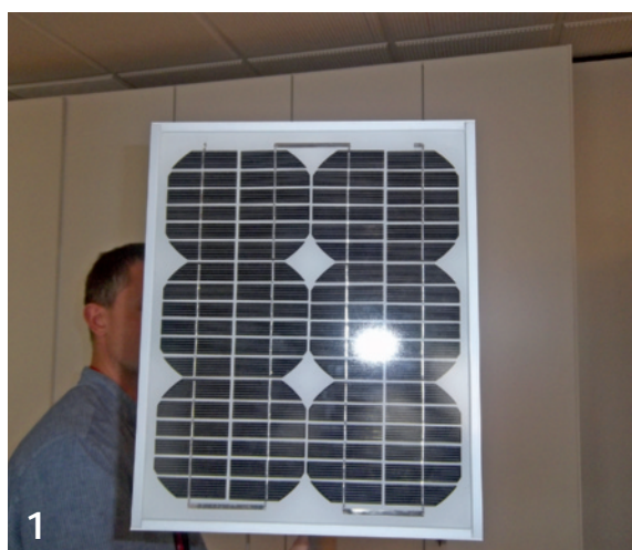
1 L'immagine inquadra il pannello solare da 10 W Ecosol Panel (355 x 290 x 30 mm)
